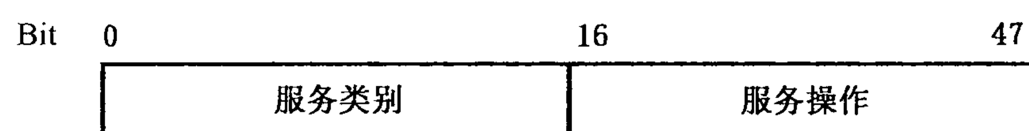
图 2 工业物联网仪表服务标识编码的完整格式
