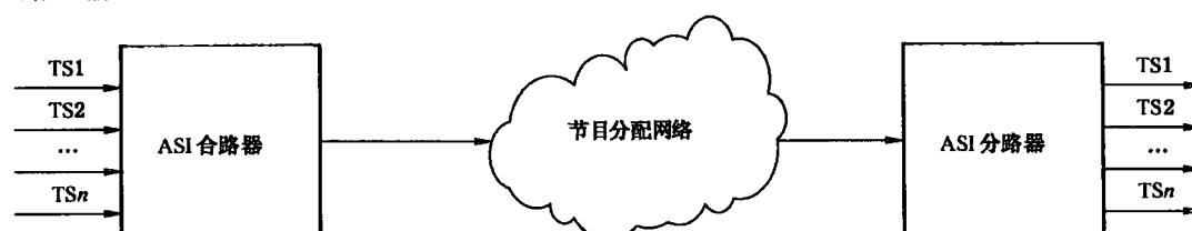
图 1 具有 ASI 合路/分路器的多路节目分配网络结构图
