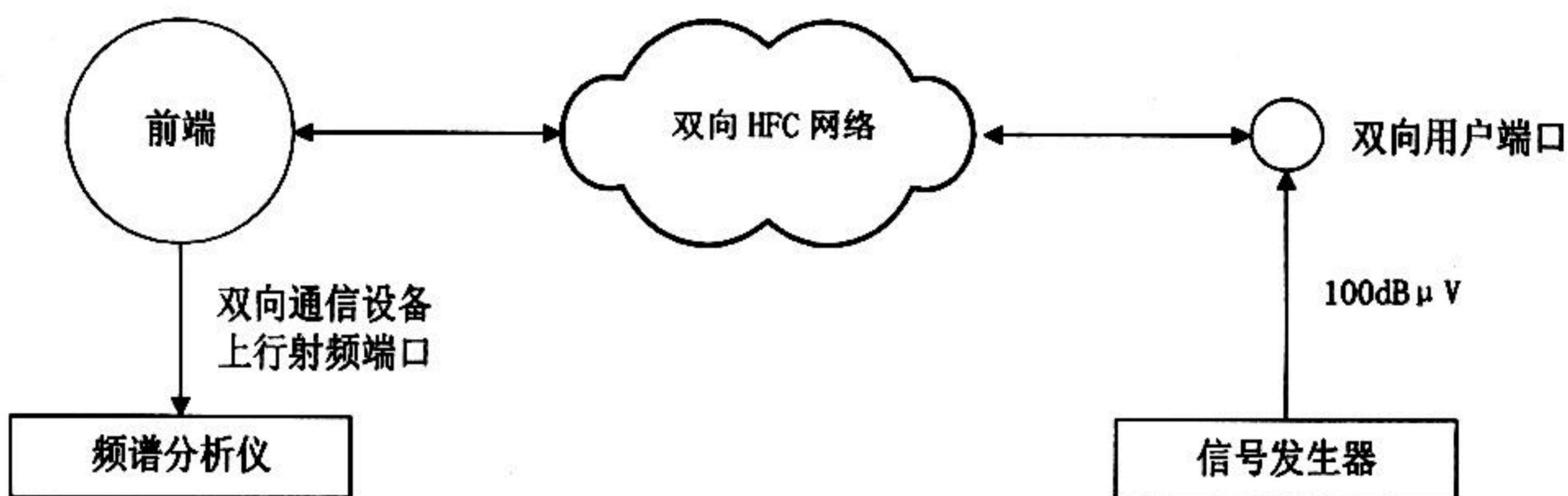
图 5 信号交流声调制比测量设备连接图
