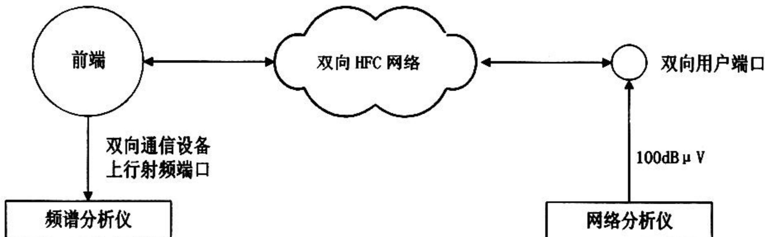
图 2 上行通道频率响应测量设备连接图
