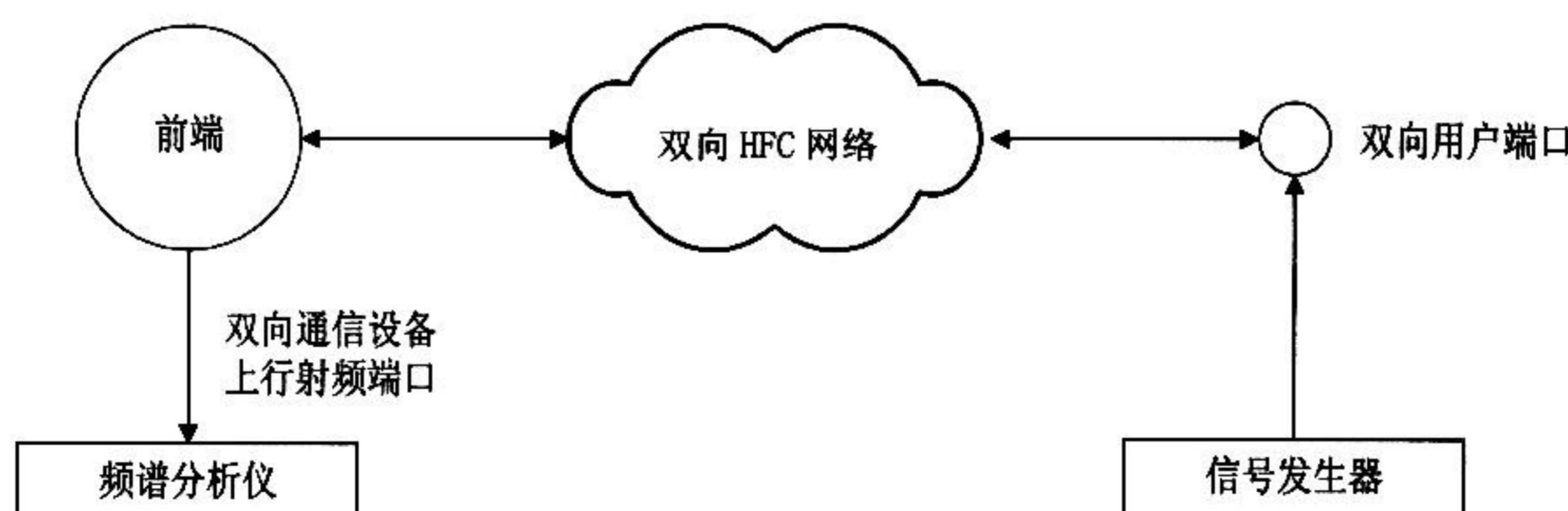
图 8 用户端口保护隔离能力测量设备连接图
