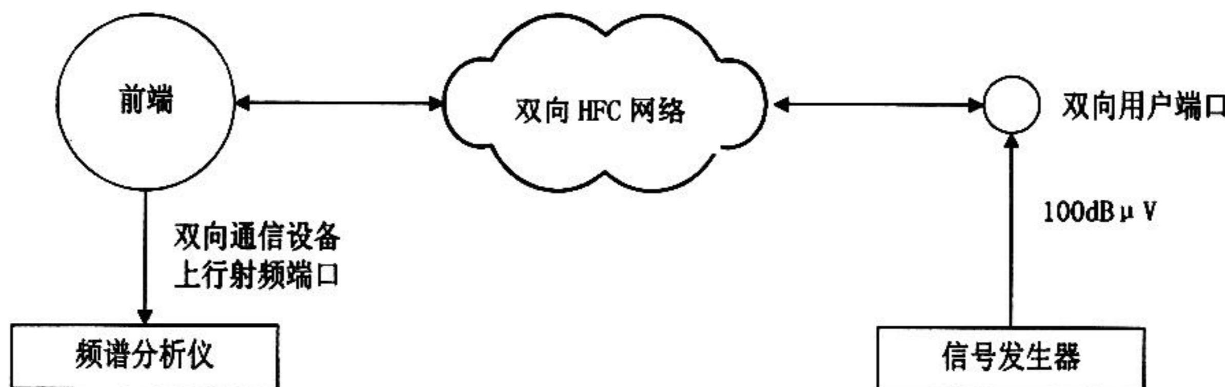
图 1 上行传输路由增益差测量设备连接图
