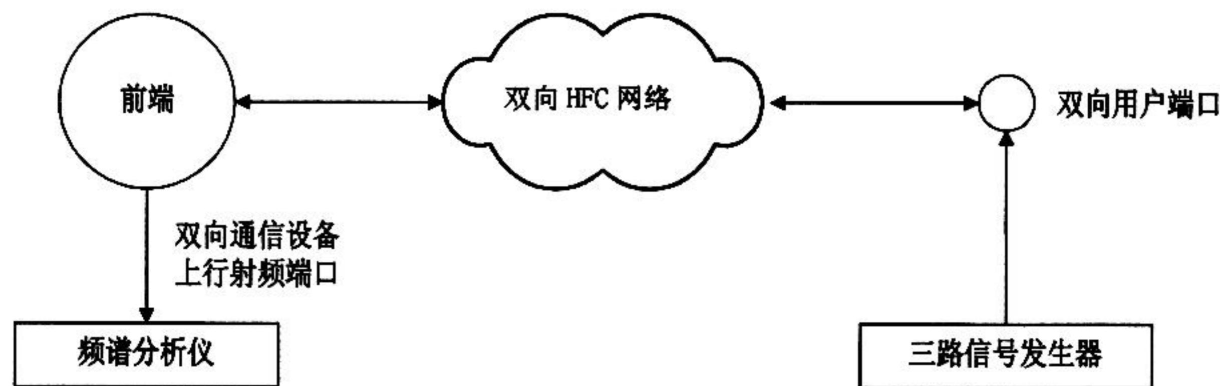
图 3 上行最大过载电平测量设备连接图
