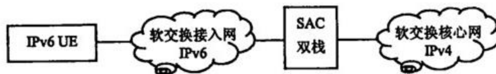
图2 软交换 IPv4 核心网，支持 IPv6 终端接入
