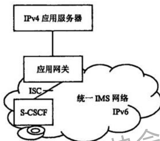
图 7 统一 IMS 网络采用 IPv6, 与 IPv4 应用服务器互通
