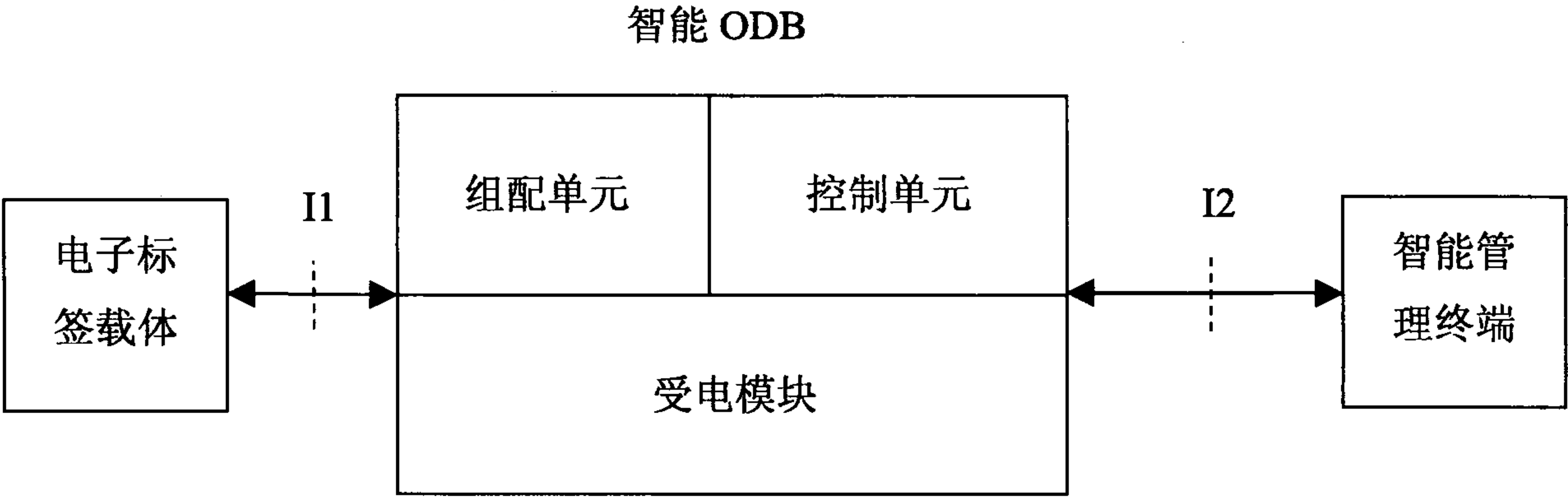
图 1 智能光缆分纤箱逻辑组成
