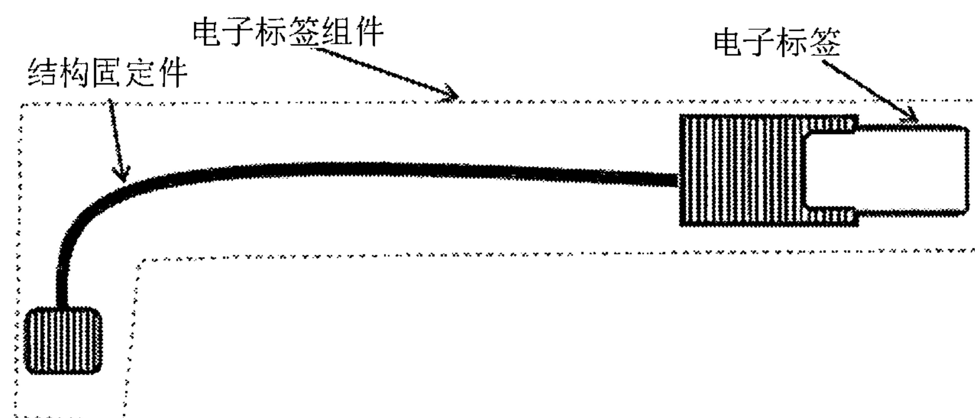
图2 电子标签组件组成示意（光缆式）
