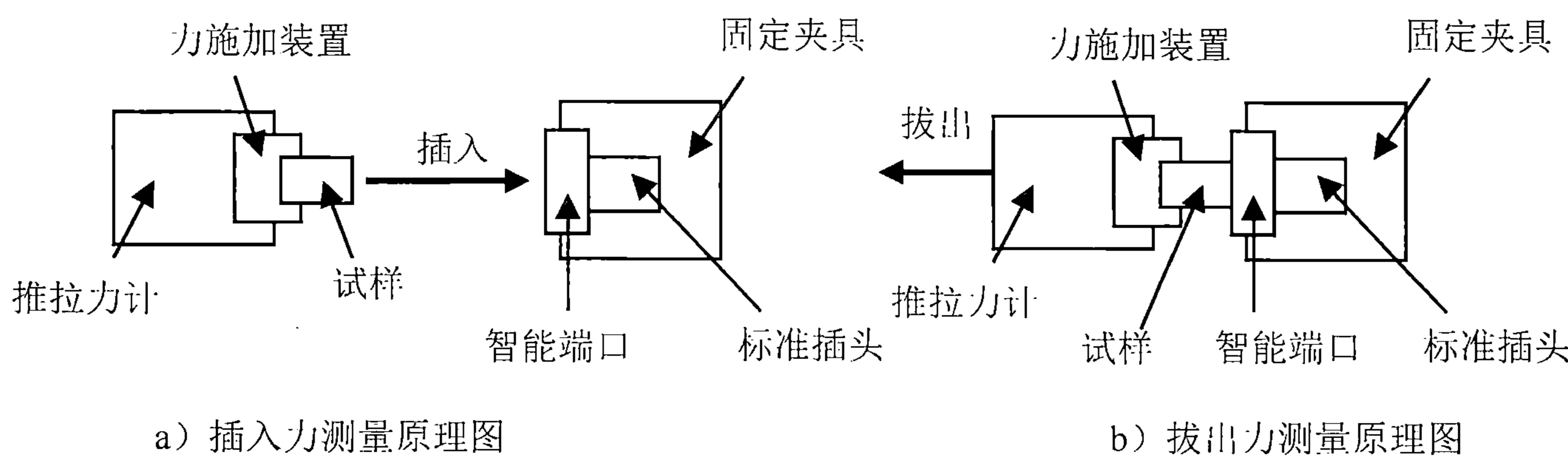
图3 插、拔力测量原理
