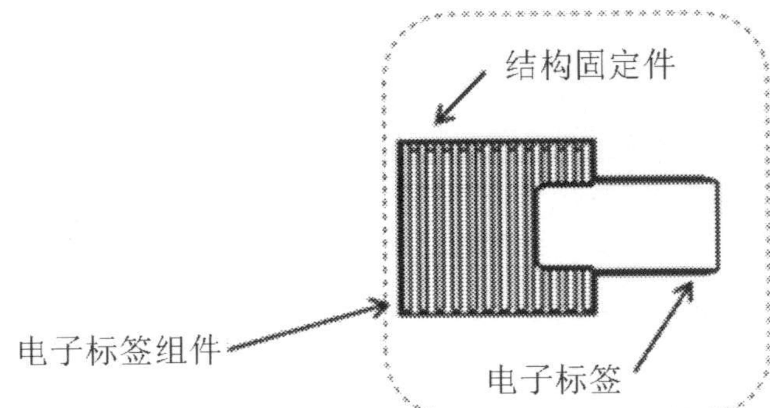
图1 电子标签组件组成示意（框套式）
