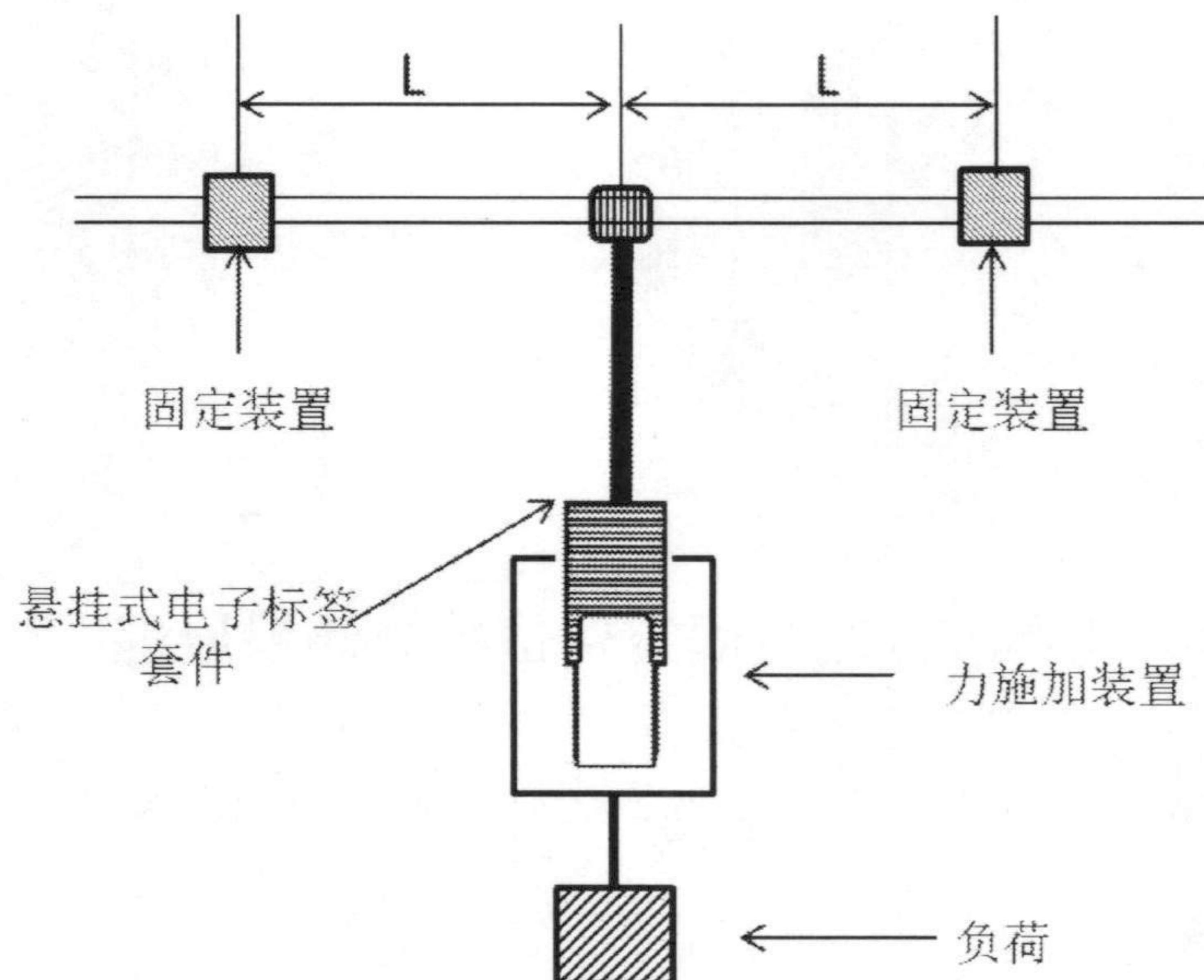
图6 光缆式标签固定件保持力测量原理
