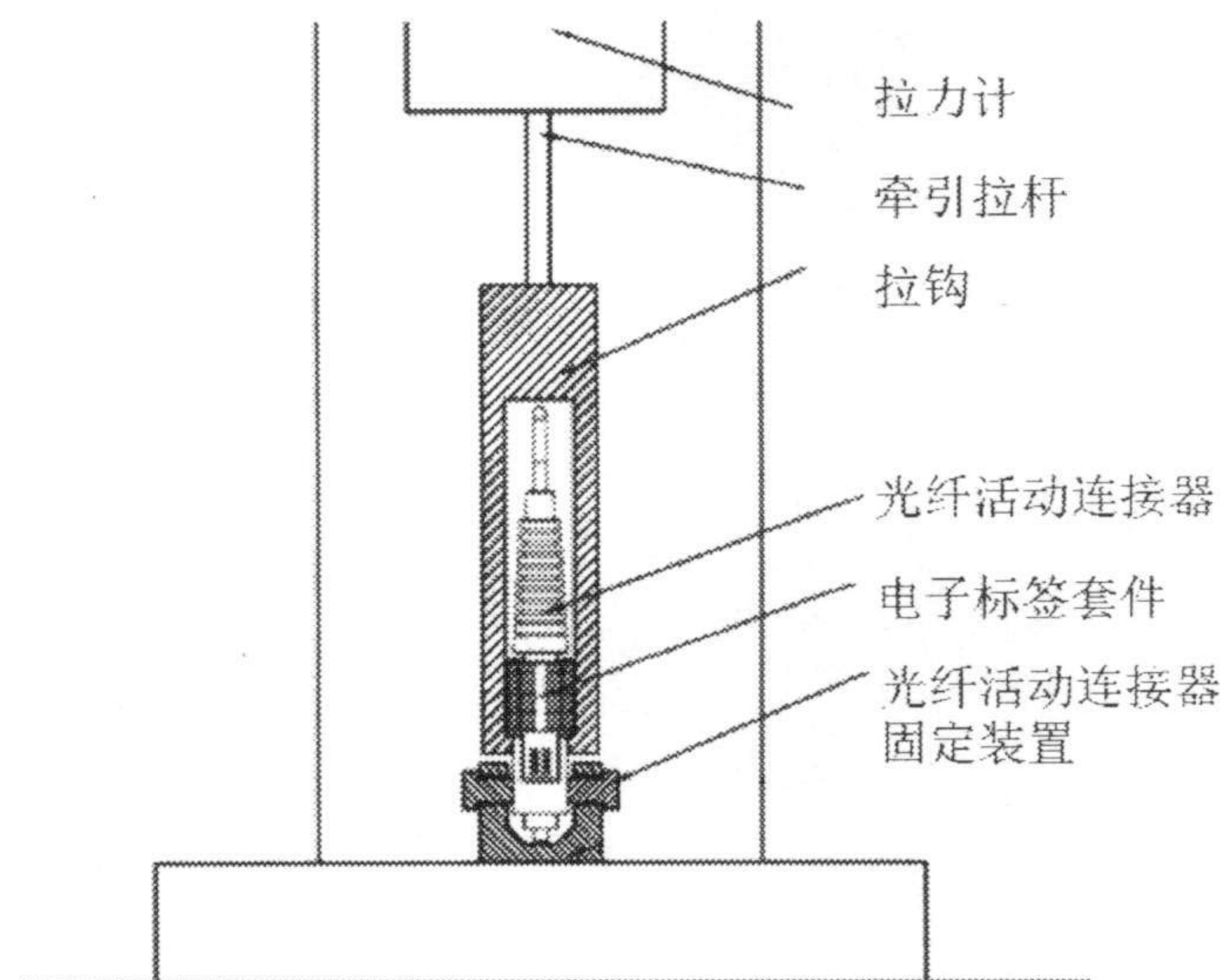
图4 框套式固定件保持力测量原理
