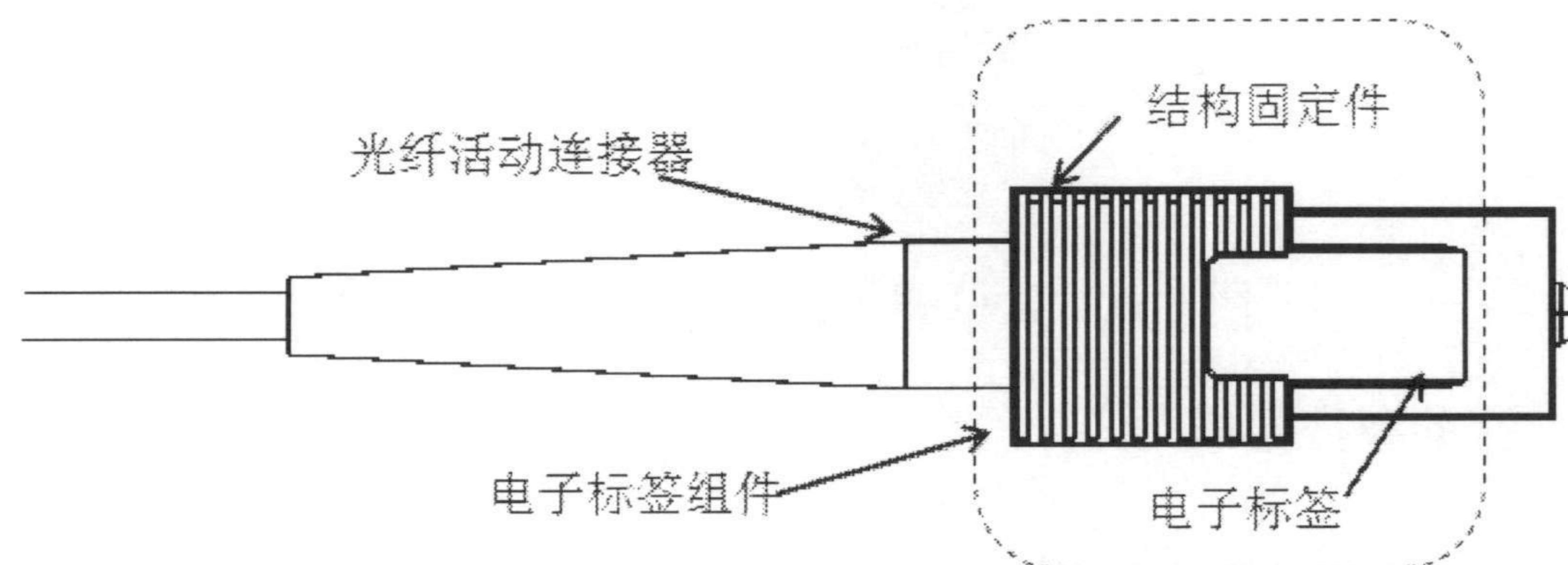
图 A.1 智能光纤连接器组成示意 (框式)
