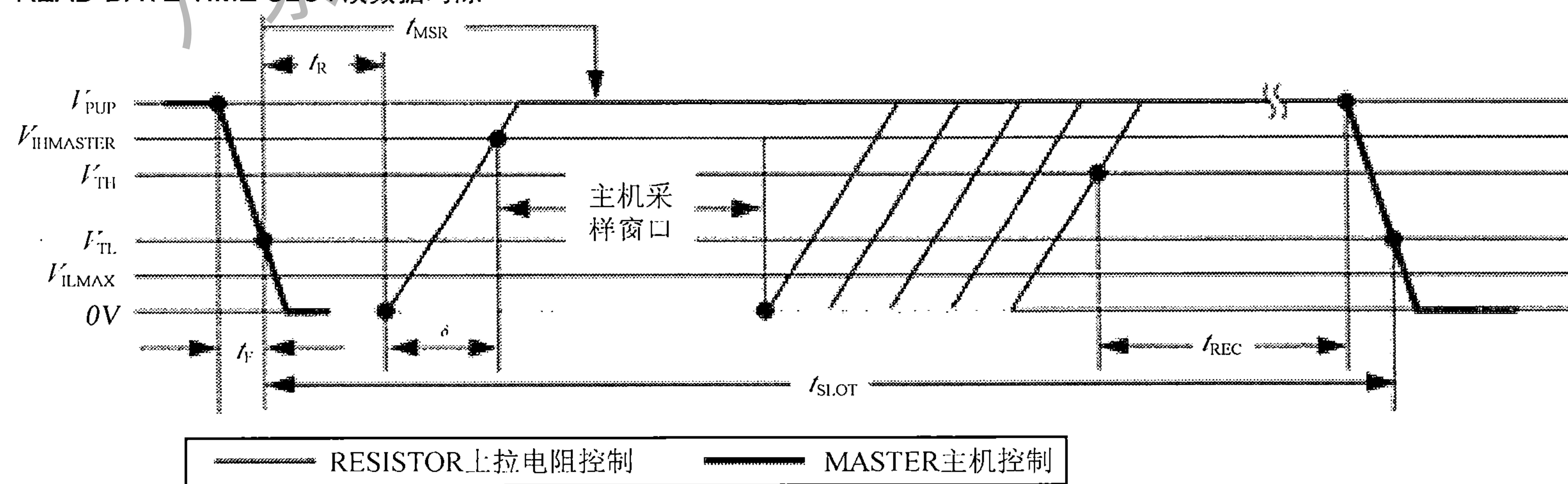
图 D.2 电子标签读写时隙
