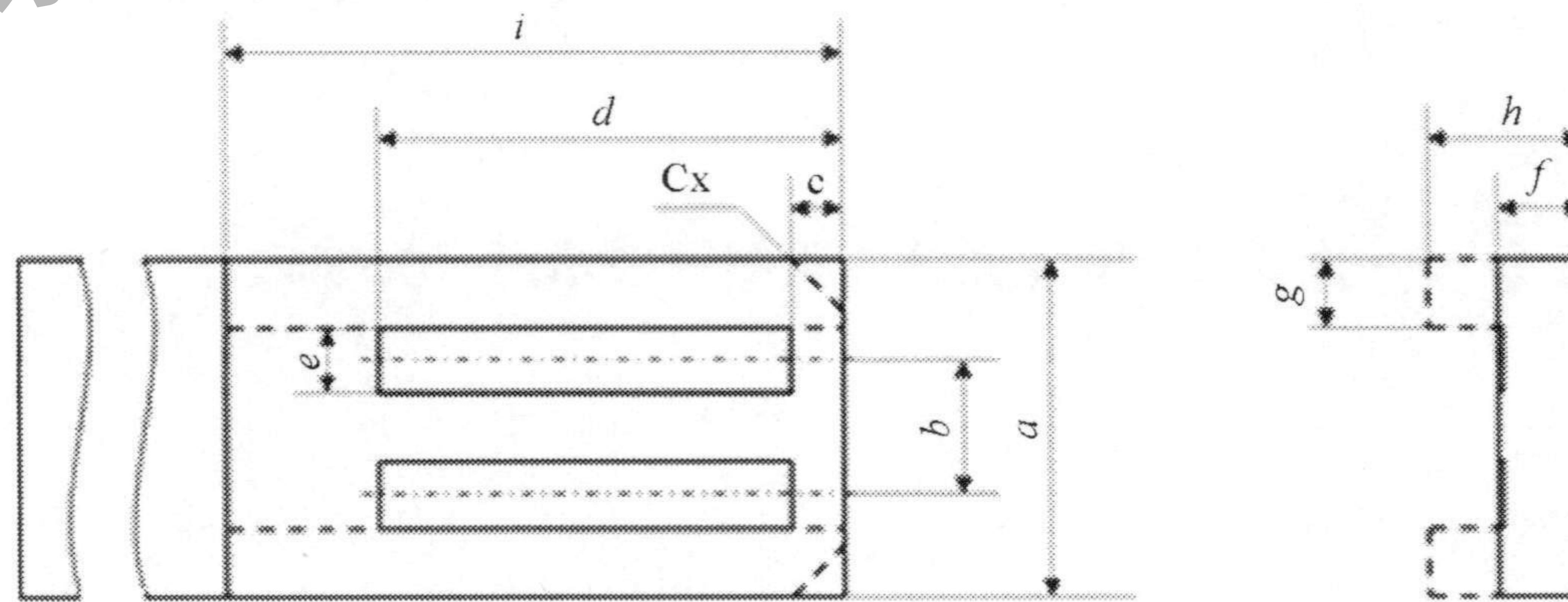
图 B.2 电子标签结构和尺寸
