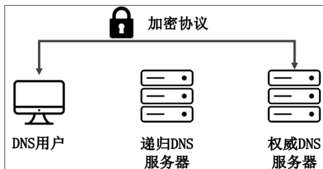
图3 用户至权威 DNS 服务器的域名解析数据加密传输
