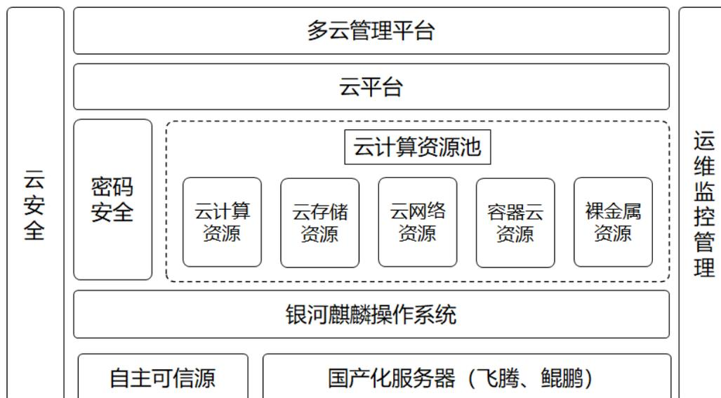
图 1 信创云系统架构
